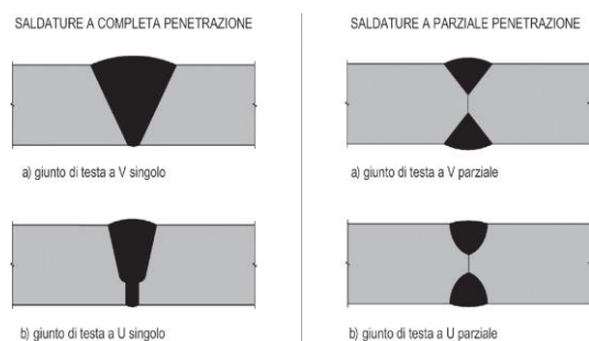
Figura 18.1. Esempi di giunti di testa con saldature a completa e/o parziale penetrazione
